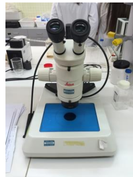
Figura 3 (sinistra) Setacci da 5 mm e 300 \mu\text{m} e figura 4 (destra) Stereoscopio utilizzato per lo smistamento del flottante, per riconoscimento ed il conteggio delle microplastiche
