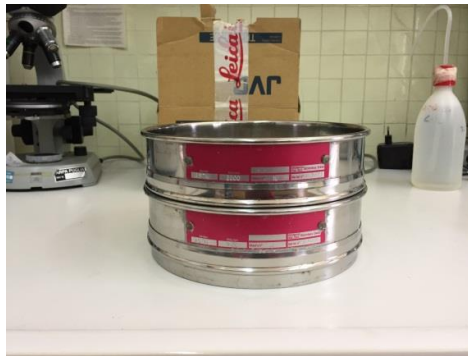
Figura 3 (sinistra) Setacci da 5 mm e 300 \mu\text{m} e figura 4 (destra) Stereoscopio utilizzato per lo smistamento del flottante, per riconoscimento ed il conteggio delle microplastiche
