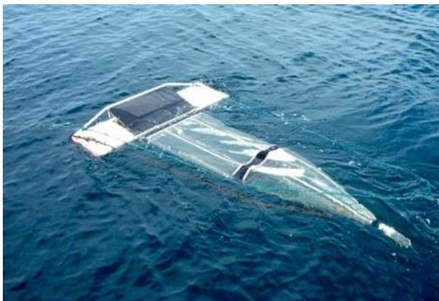
Figura 2 Rete di tipo "manta" utilizzata per il campionamento superficiale delle microplastiche
