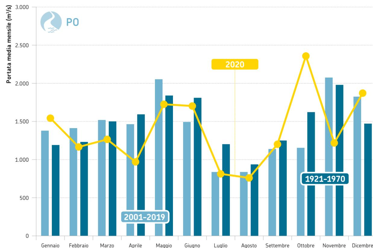
**FIGURA 2** Fiume Po, sezione idrometrica di Pontelagoscuro (FE) (bacino sotteso di 70.091 km<sup>2</sup>). Andamento temporale della portata media annuale dal 2001 al 2020 (in giallo) a confronto con la media poliennale 2001-2019 (in azzurro)
