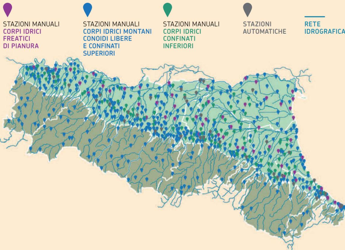
oraria, i livelli di falda in circa 40 stazioni ritenute rappresentative dei principali corpi idrici di pianura. Il livello delle falde viene espresso come **soggiacenza**, ovvero la **profondità della superficie libera dell'acqua**, misurata ad esempio all'interno di pozzi, rispetto al piano campagna. I **corpi idrici sotterranei più rappresentativi**, per valutare a scala regionale le variazioni di livello delle acque sotterranee, sono i seguenti:
