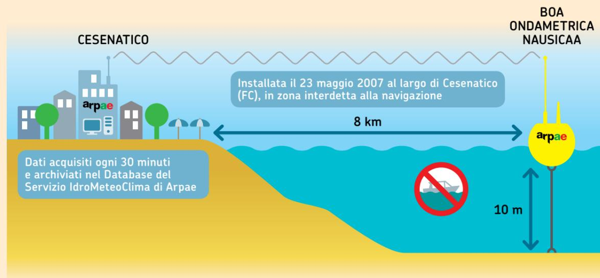
I dati ondametrici (**altezza e direzione delle onde**) sono acquisiti dalla **boa ondometrica "Nausicaa"** di Arpae Emilia-Romagna. I dati sono **acquisiti ogni 30 minuti** e archiviati nel Database del Servizio IdroMeteoClima di Arpae, accessibile tramite il servizio web Dext3r (<https://simc.arpae.it/dext3r/>).
