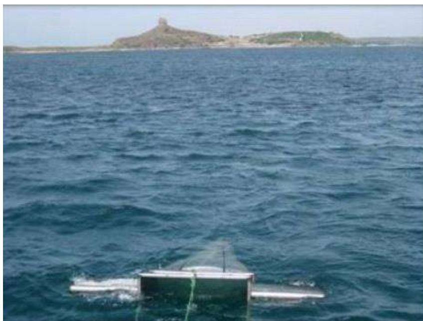
Figura10.12: Rete Manta (Foto A. Camedda Cnr-IAMC Oristano)
