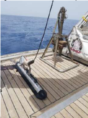
Figura 6.2: Side Scan Sonar utilizzato per le indagini geofisiche
