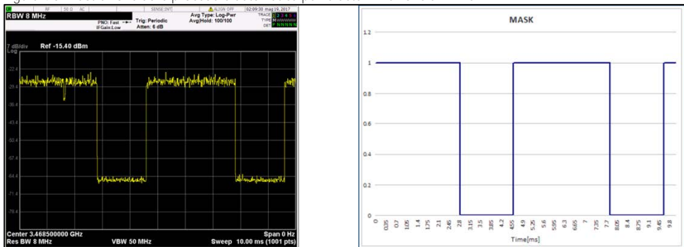
Figura 4.8: Illustrazione della procedura automatica per la determinazione di FTDC
